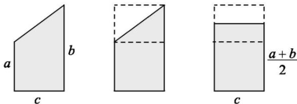
Die Fläche  $A$  des Trapezes ist so groß wie die eines *Rechtecks* mit gleicher Breite  $c$  und dessen Länge der Mittelwert der Längen der beiden parallelen Trapezseiten  $a$  und  $b$  ist:
