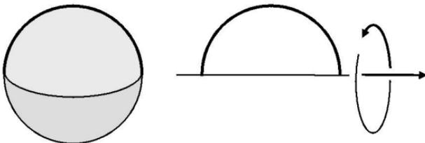
Das Volumen der Drehkörper kann mit Hilfe unserer Integrale berechnet werden. Die Grundidee ist die Zerlegung des Körpers in viele flache **Zylinder**.
