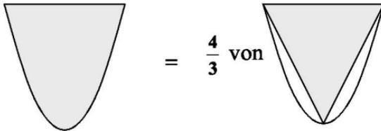
$$\text{Fläche des Parabelsegments} = \frac{4}{3} \text{ der Dreiecksfläche}$$
