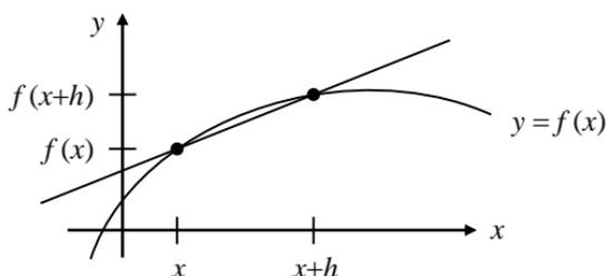
Wenn sich  $h$  der Null nähert, so rücken die Punkte  $x$  und  $x+h$  immer mehr zusammen und die Sekanten nähern sich immer mehr der Tangente. In diesem Sinne bezeichnet man die Tangente (Tangentensteigung) als den „Grenzwert“ der Sekanten (Sekantensteigungen, siehe Anhang 1: Geraden, Abschnitte 3, 6 und 7). Also:
