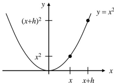
Wir berechnen zunächst die Steigung der Sekante. Das Ergebnis ist kein Bruch mehr,  $h$  steht nicht mehr im *Nenner*. Man kann nun gut überblicken was passiert, wenn  $h$  gegen  $0$  geht - man kann praktisch einfach  $h = 0$  setzen.
