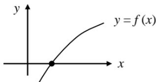
Mit Hilfe der *Tangenten* hat Newton ein Näherungsverfahren zur Lösung von Gleichungen gefunden. Die folgende Skizze enthält die Grundgedanken des Newton-Verfahrens:
